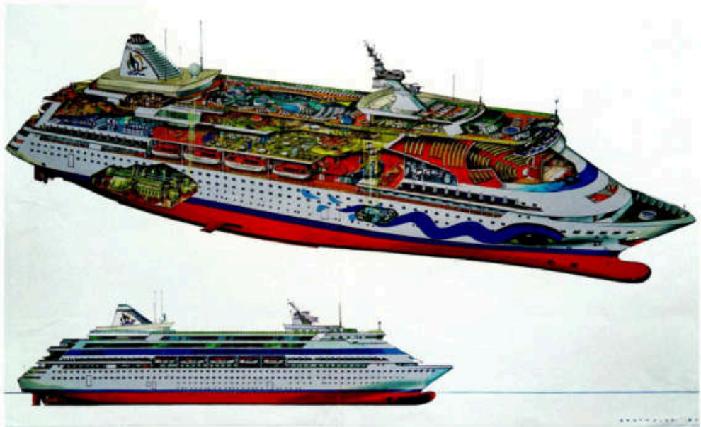
Kreuzfahrtschiff AIDA im Röntgenschnitt (2003)
