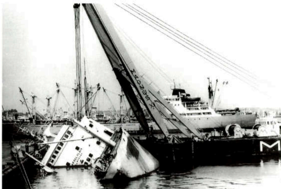
MAGNUS XII beginnt mit dem Versuch die MAR DEL PLATA aufzurichten
