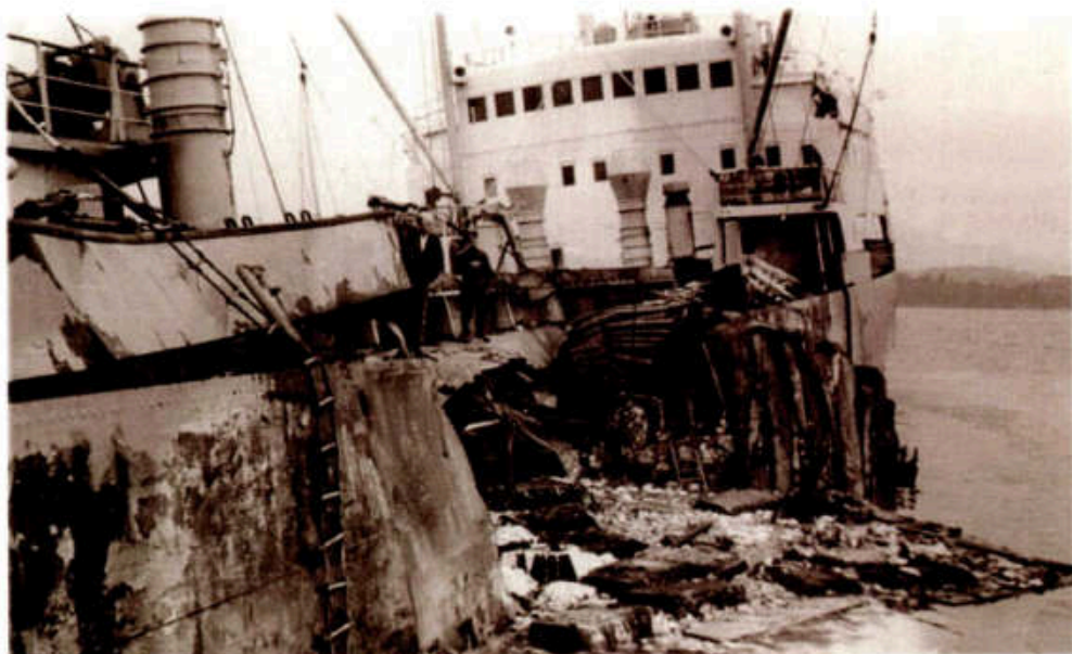
MS SAALE mit aufgerissener Außenhaut
