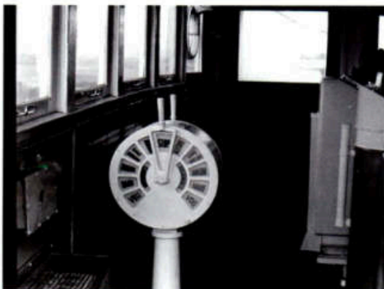
Maschinentelegraf auf der Brücke des MT LÜTZKENDORF
