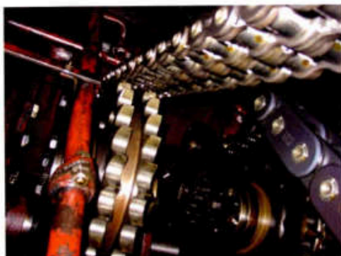
Kettenantriebe im Kurbelraum für Nockenwelle, Rootsgebläse; (links) Blick durch den Kurbelraum längs des Motors: rechte Pleuellstange des oberen und unteren Abgasschiebers, (rechts)
