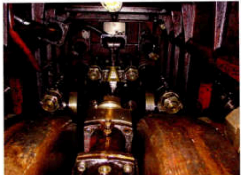
Zwei der 8 Zentrifugen für Öl und Brennstoffe (links), unten das Pleuellager, darüber linker und rechter Pleuel des Abgasschiebers, Mitte Kreuzkopf des Hauptkolbens (rechts)
