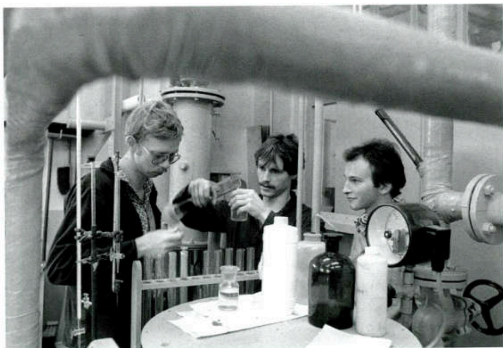
Kesselwasseruntersuchung im Komplexlabor der IHS, Sektion Schiffsbetriebstechnik (1986)
