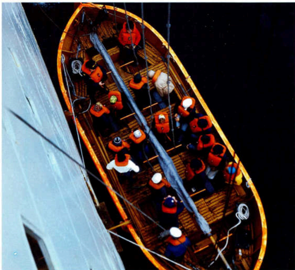
Das vollbesetzte Boot wurde zu Wasser gelassen. Noch hängt es an den Taljen aus Stahldraht an der Backbord-A-Decksporte. Vor dem Einsetzen der Boote wurden die Bootsbesatzungen aus Gewichtsgründen bis auf drei Seeleute an der Seitenporte abgegeben. Manöver zu Schulungszwecken verlangten daher immer ruhiges Wetter oder eine geschützte Bucht bzw. Hafen.
