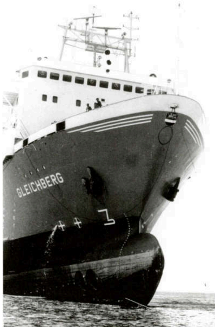
Das Vorschiff der GLEICHBERG saß etwa 30 Meter vorgeschoben auf dem festen Korallengrund, während sich das Achterschiff im tiefen, freien Wasser befand. Die Backbordschlagseite betrug 9 Grad.
