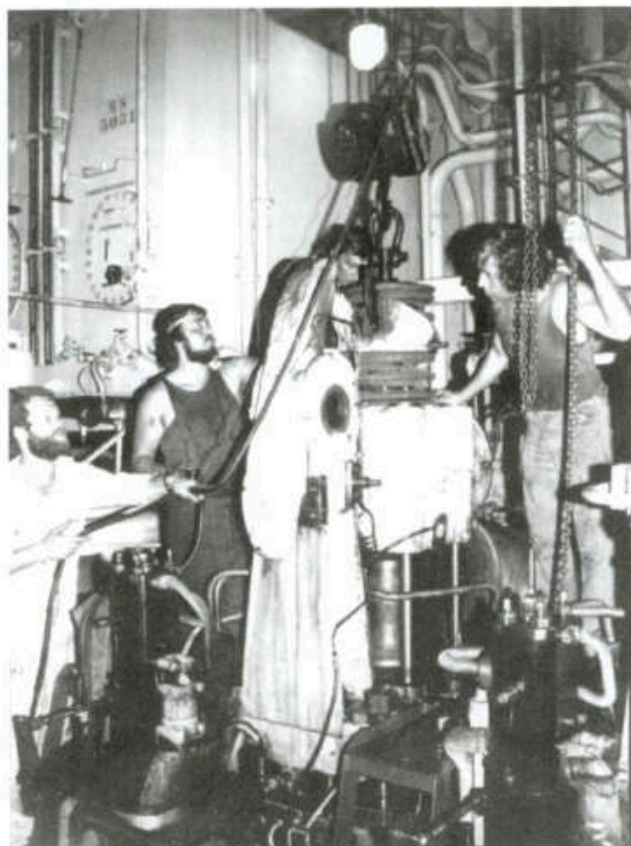
Auslassventilwechsel am Hauptmotor des MS GRÖDITZ
