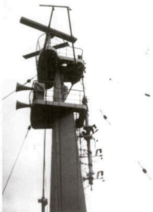
Das abgebrochene Topstück des Großmastes ist gelascht.
