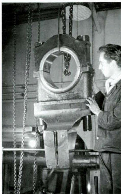
1. Ingenieur G. Fülkel mit Pleullager und Bruchteil in Vorderansicht
