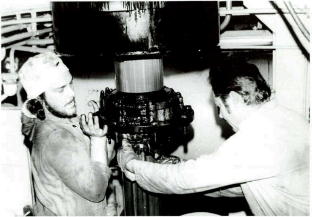
Chief Stier und Maschinen-Assi Meißner bei der Demontage einer Kolbenstangenstopfbuchse des Hauptmotors MAN K 8 P 70/120 E Typ XD)
