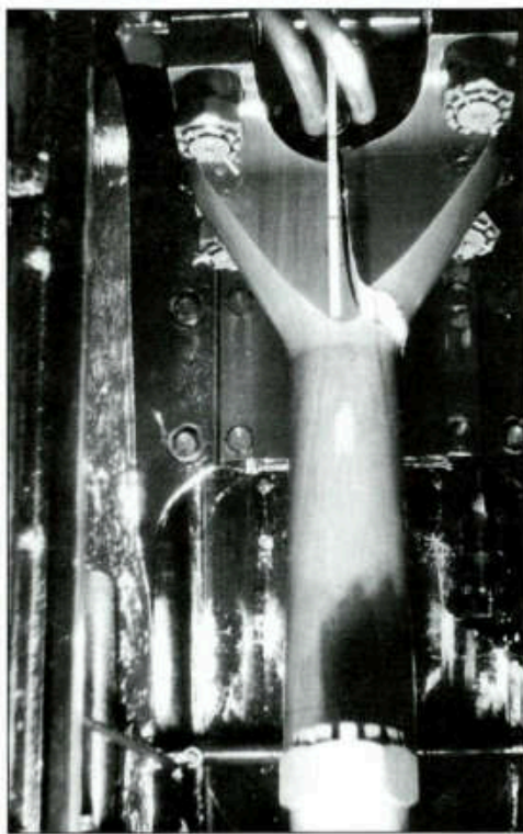
Bruch der Pleulstangengabel – einmaliger Maschinenschaden in der gesamten DSR-Geschichte
