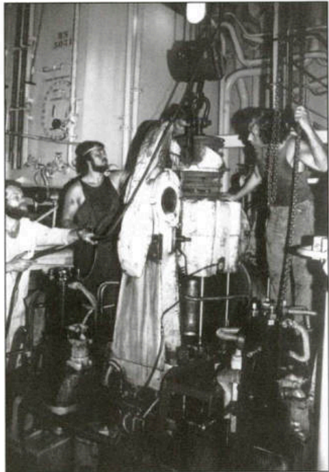
MS GRÖDITZ – Auslassventil wechseln
